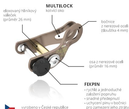
Paddle FX je kotvítko pro popruhy o šířce 50 mm. Je dimenzováno pro trickline do 14 kN tahu. Uplínací mechanismus umožňuje předeptnutí popruhu v jednom směru, zatímco v druhém směru je popruh pevně ukotven. Díky obýlým hranám nehrozí poškození popruhu. Středová osa o průměru 26 mm zachovává více než 85% pevnosti popruhu. Bočnice poskytují dostatečný prostor pro ukotvení dvou popruhů současně. Paddle FX je kompatibilní s většinou dostupných spojovacích prvků (šekly, karabiny, mailonky atd.).
